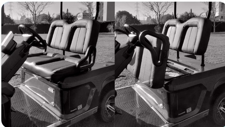
Abaixo do banco dianteiro é encontrada a bateria de tração do veículo, a qual pode ser acessada levantando o assento. Para levantar o assento, segure nos apoios de braço e puxe a parte traseira do banco (próxima ao encosto) em direção ao painel dianteiro e volante do veículo.
